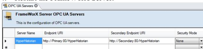
Figure 4 - OPC UA Server Redundancy
