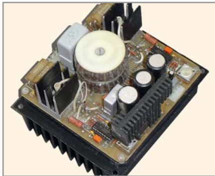
Рис. 4. Внешний вид опытного образца двухканального стабилизатора тока
