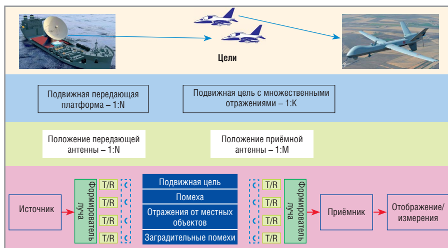
Рис. 1. Схема моделирования сценария в интегральной среде с помощью САПР Keysight SystemVue
