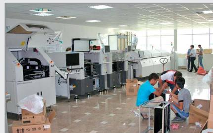
автоматической оптической инспекции VT-RNS II фирмы Omron. Системы VT-RNS, успешно используемые на ведущих производственных предприятиях по всему миру, доказали свою надёжность и эффективность. Благодаря работе по запатентованной фирмой Omron технологии трёхцветной кольцевой подсветки установка точно находит и определяет дефекты монтажа компонентов и контролирует форму образовавшихся паяных соединений, позволяя определить их надёжность и качество.
