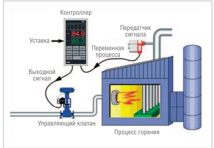
Рис. 3. PID-контроллер управляет процессом автоматически
