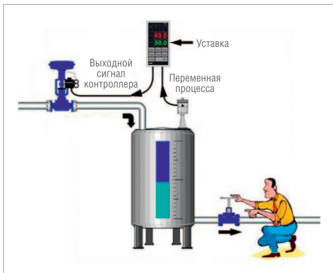
Рис. 6. Пропорциональный контроль уровня в процессе ручного отбора воды из бака
