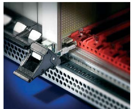
Рис. 5. Установка модуля CompactPCI с помощью специальной ручки
