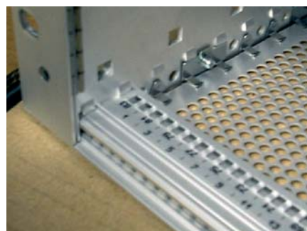
Рис. 8. Крепление поперечного рельса к боковой панели
