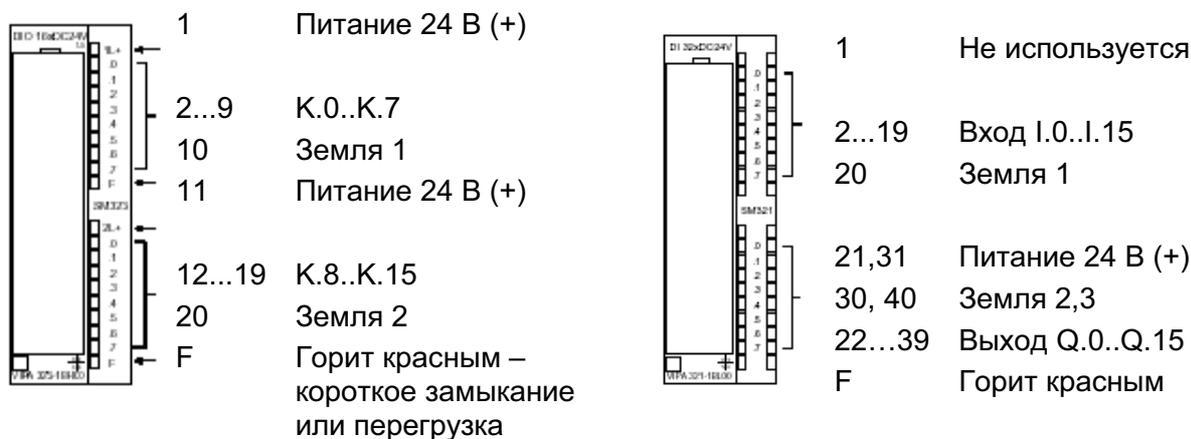
Рис. 77. Назначение контактов SM 323
