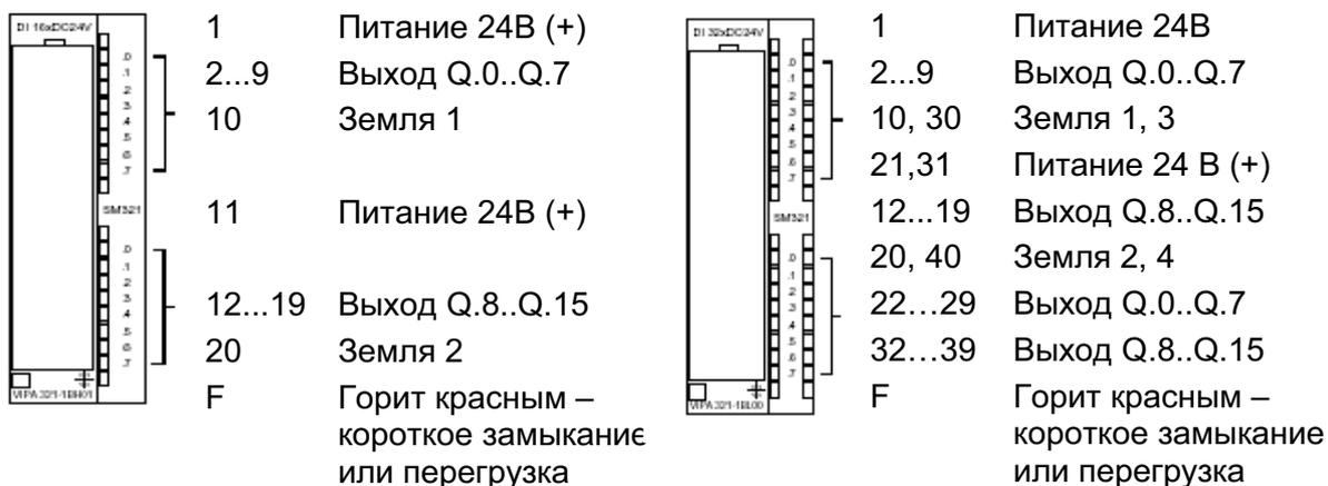
Рис. 75. Назначение контактов SM 322
