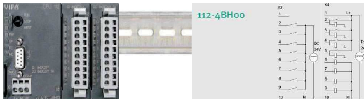
Рис. 2. Micro-PLC 112 с дискретными входами и выходами, схема подключения дискретных каналов
