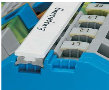
Держатель полоски для непрерывной маркировки WFB устанавливается через каждые 10 клемм.
