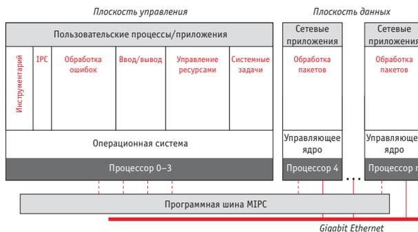
Рис. 4. Вариант реализации плоскости данных и плоскости управления при асимметричной многопроцессорности
