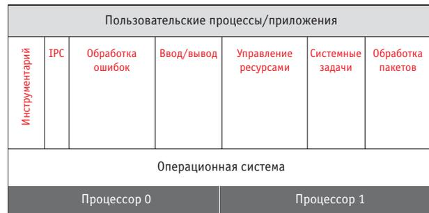
Рис. 2. Симметричная многопроцессорность с двумя процессорами
