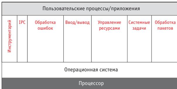
Рис. 1. Традиционная однопроцессорная система
