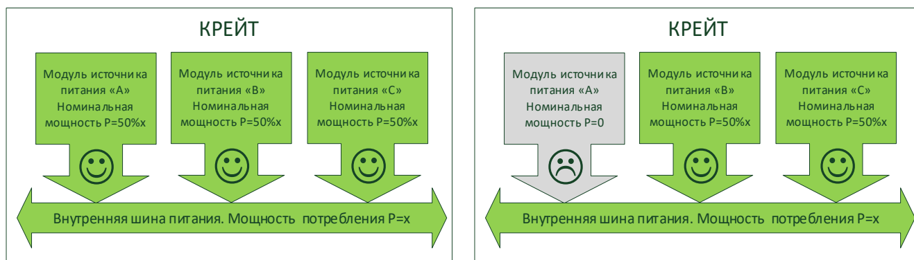
Рисунок 8 - Схема с избыточным модулем источника питания
