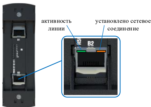
Рисунок 63 - Индикация интерфейса RJ45 модулей ST XX 0XX
