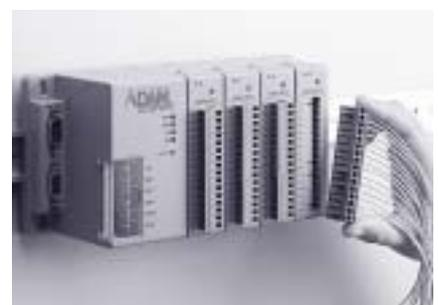
Подключение источников сигналов. Клеммные колодки имеют возможность извлечения
