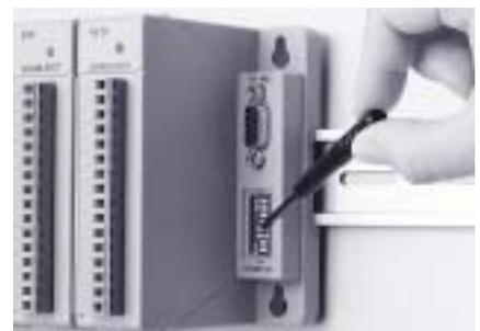
Установка сетевого идентификатора с помощью 8-позиционного переключателя
