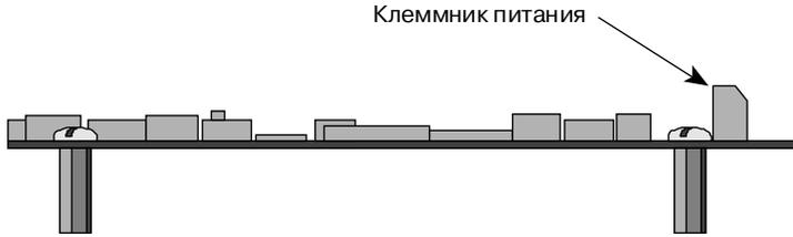
Рис. 5. Монтаж модуля 5066 на панель
