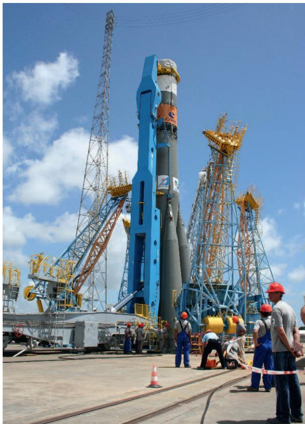
Рис. 1. Установка РН «Союз» в стартовую систему ГКЦ
