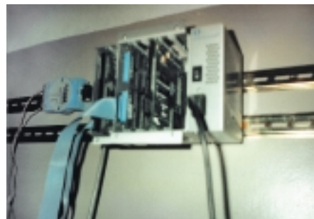
Рис. 3. В качестве локального контроллера в системе использован IBM PC совместимый контроллер MicroPC фирмы Octagon Systems
