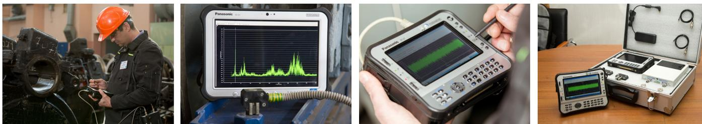
Это, во-первых - универсальный комплекс вибродиагностики буксовых узлов колесных пар с цилиндрическими подшипниками и подшипниками кассетного типа. Комплекс предназначен для вибродиагностики буксовых узлов колесных пар при промежуточной и полной ревизии букс. В состав комплекса входят: система ОМСД-02 или СБД-1, стенд СВ-01НМ1;
